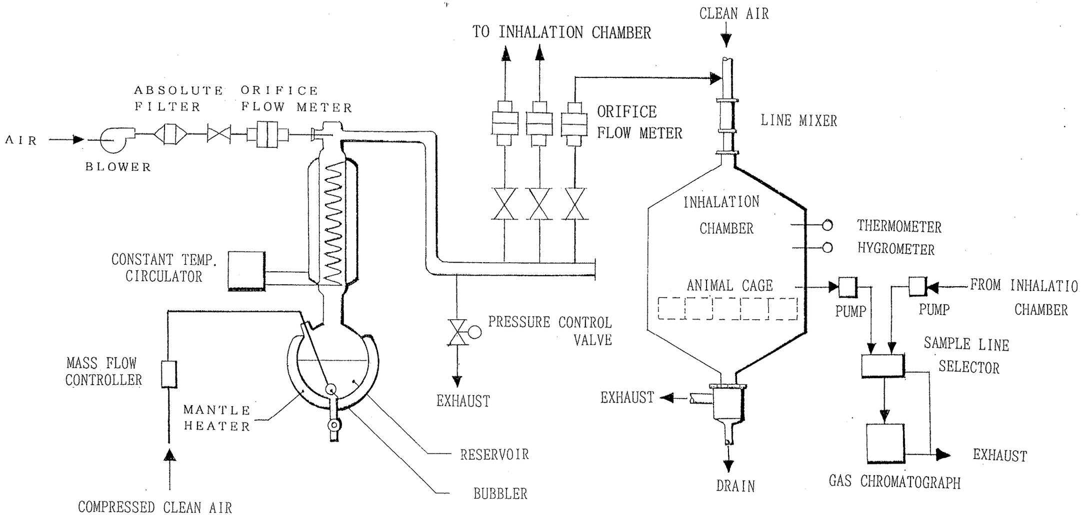
FIGURE 1 p-DICHLOROBENZENE VAPOR GENERATION SYSTEM AND INHALATION SYSTEM
