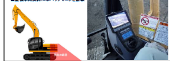
■重機車両関係にはバックモニタを搭載
