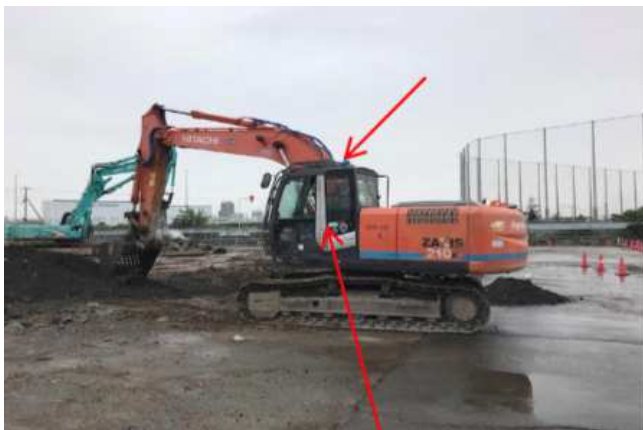
重機災害防止のバックホウ停止状態合図の青色回転灯処置
