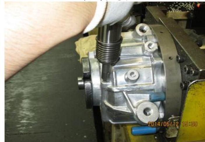
先端にポンチを取り付けた、エアーハンマーを設置し、かしめ作業を行うようにした。
