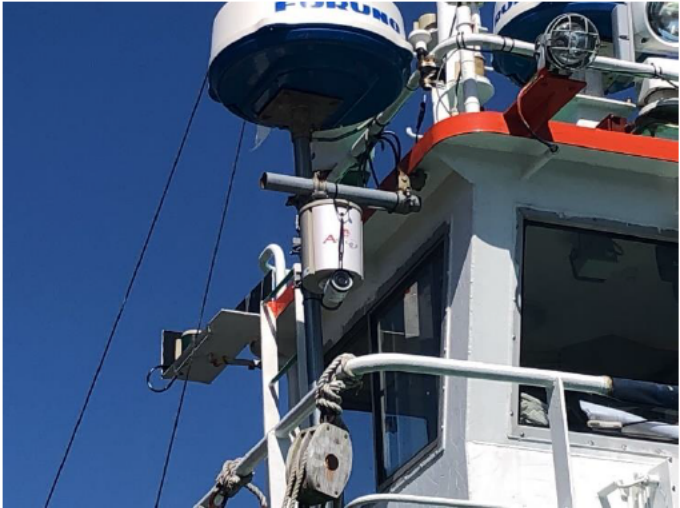
作業船へのカメラ取付
