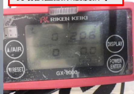
現場設置酸素濃度計↓
