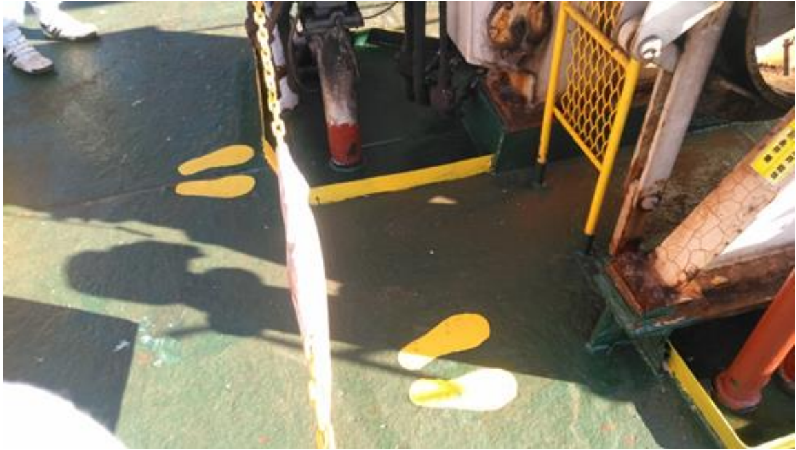
防護柵と操作者位置明示
