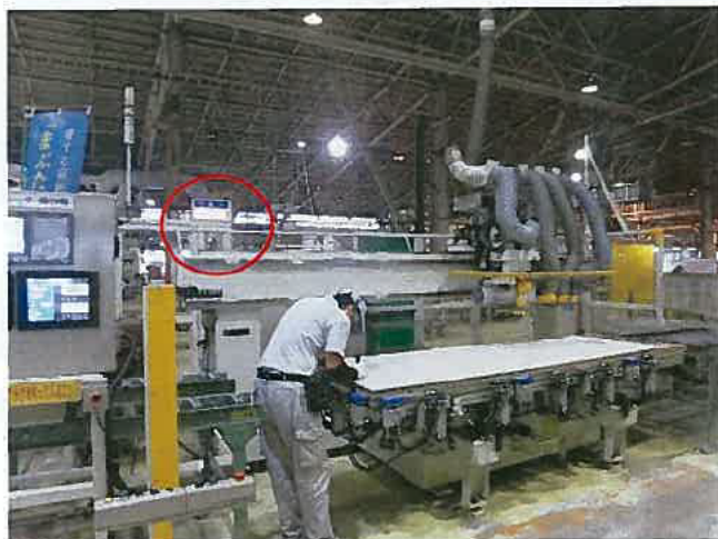
停止中の表示になったら設備の稼働範囲内に作業者は立ち入る
