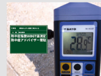
熱中症指数WBGT値の計測 熱中症対策アドバイザーでの現場 常駐巡視
