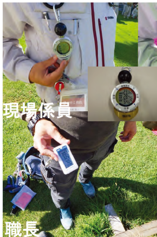
携帯用熱中症指数計(アラーム付き) によるリスクの見える化
