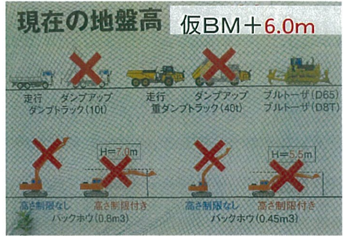
盛土地盤高さ +6.0m時点での稼働できる車両一覧
