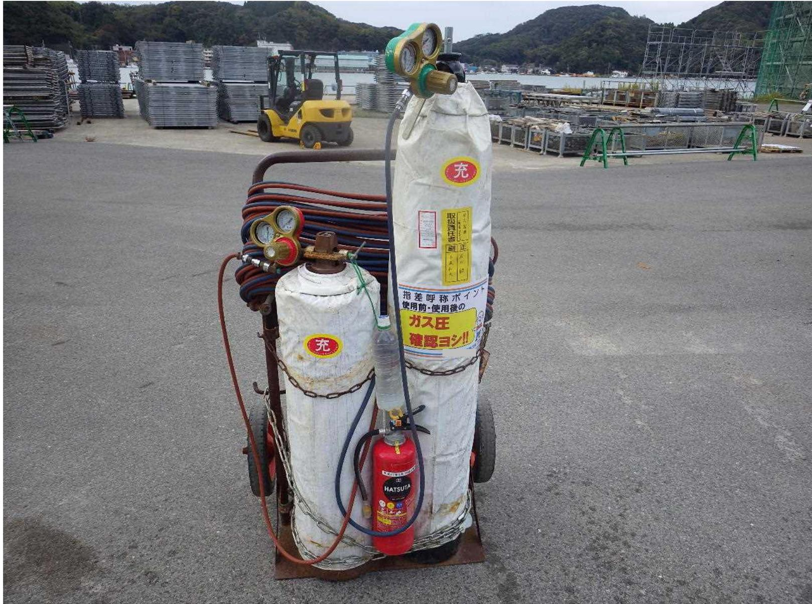
ガス溶接器使用前、使用後においてガス圧の管理を徹底するように指差呼称ポイントを表示。
