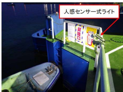
グラブ浚渫船通船乗降口
