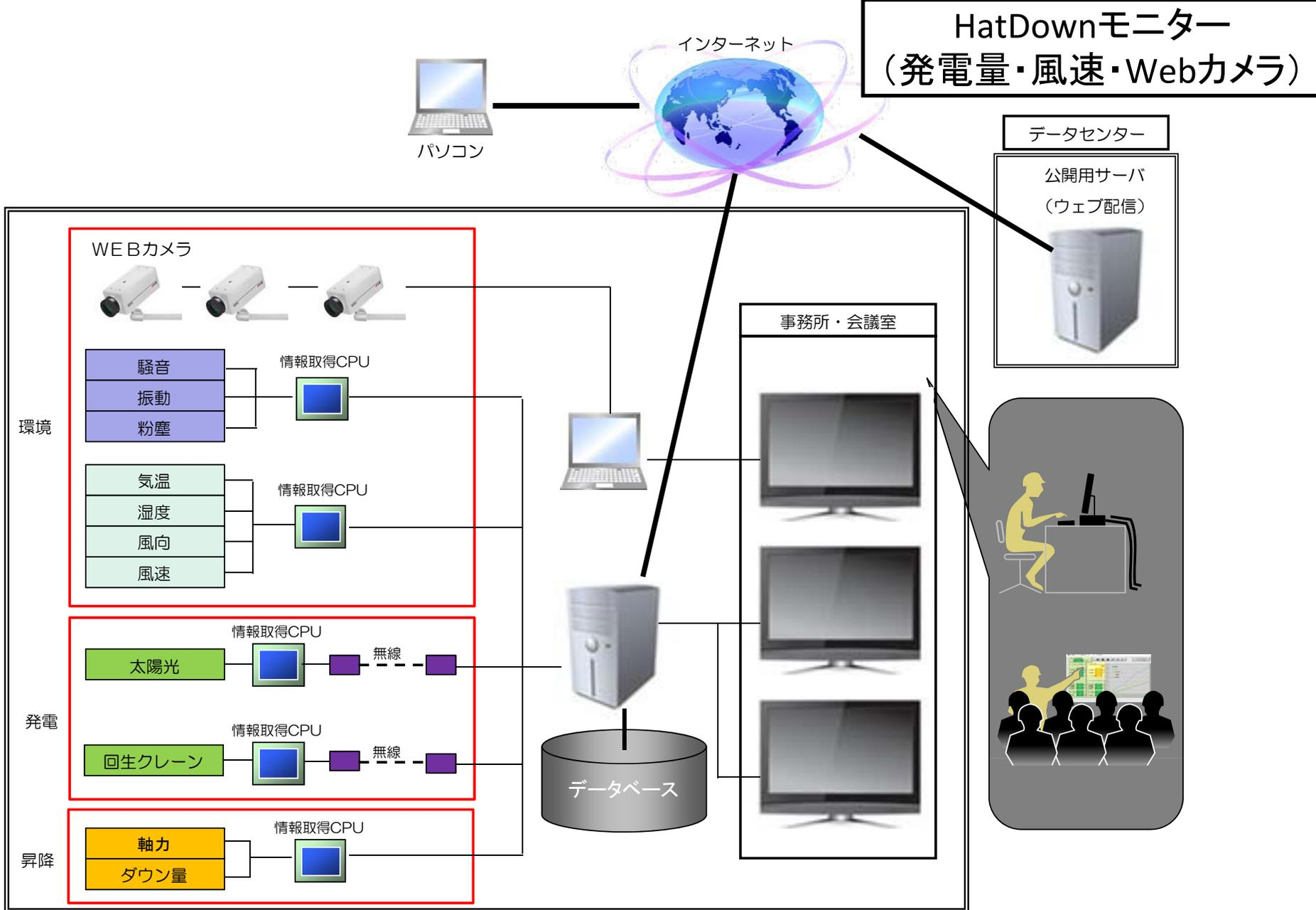
太陽光パネルによる発電量や風速、屋上の状況等をWebで確認できるシステムを構築した。作業所の様々な情報をリアルタイムで「見える化」した。(予定)
