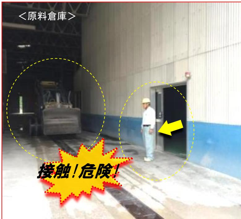
■問題点: 原料倉庫の自動ドアの前には通路があり、動力車や入荷トラックが頻繁に通っている。自動ドア内側から人が飛び出し、動力車との接触の恐れがあり非常に危険である。
