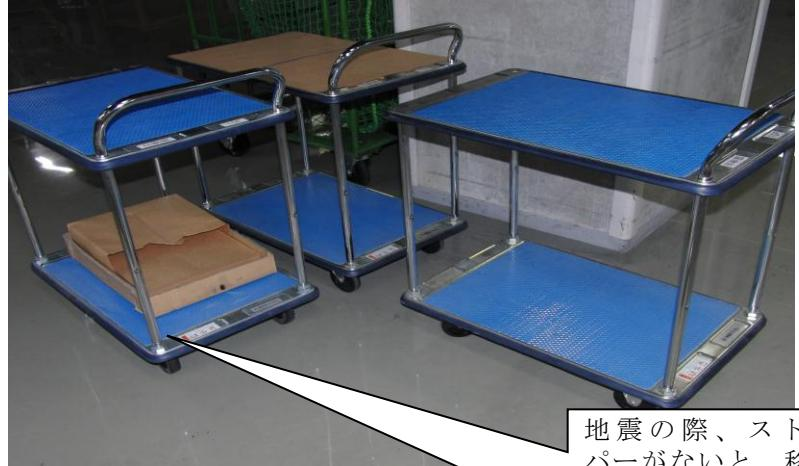
地震の際、ストップバーがないと、移動して凶器となる可能性がある。車輪二ヶ所にストップバーを取り付ける。
