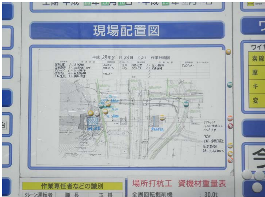
現場配置図：埋設管・架空線表記
