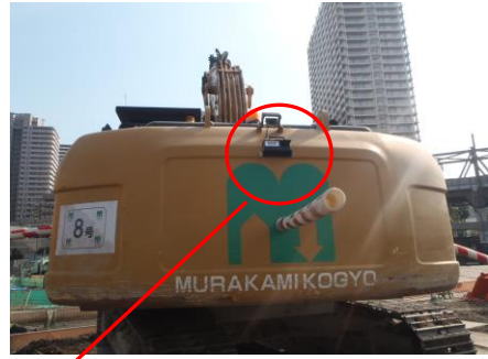
センサー設置状況
