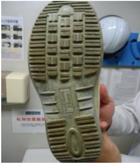
例①: GOOD!! 滑り止めの溝が良好
