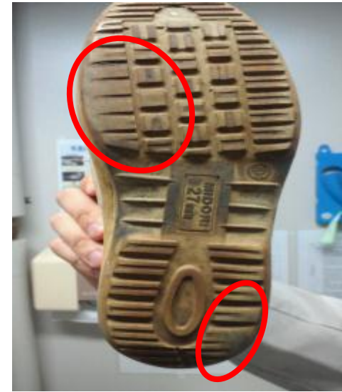
例③: 要交換 →滑り止めの溝が擦り減っている
