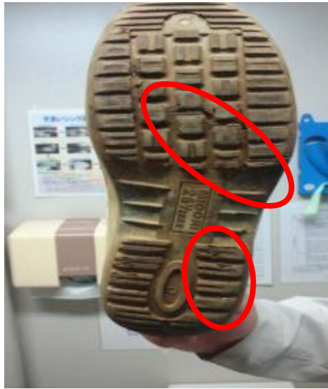
例②: 要交換 →亀裂箇所がある
