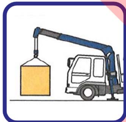
ユニック前方吊り
