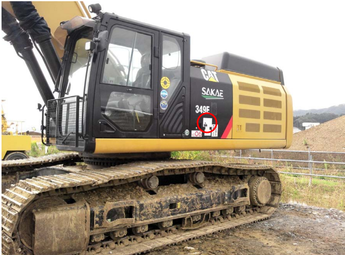
写真-1 バケット重量および最大積載重量表示
