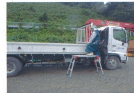
荷台への昇降時には立馬を使用する
