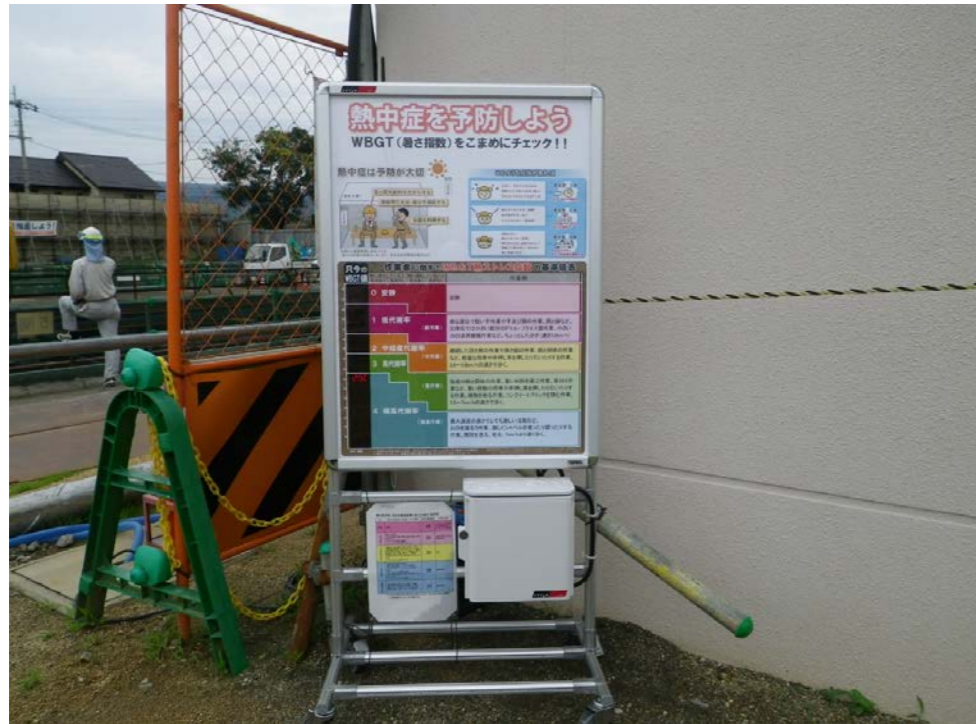
作業員や場内関係者が入り口にてWBGT値を確認できるように、現場入り口に設置
