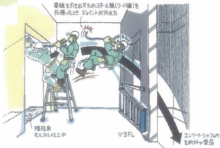
3 脚立と型枠の横ばたパイプに渡した足場板が外れて転落
