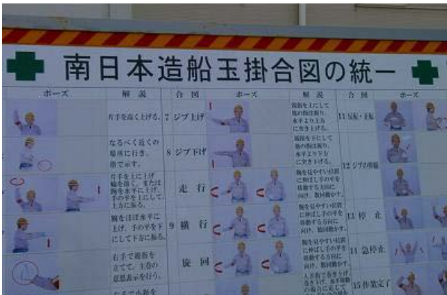
玉掛け合図統一の掲示板
