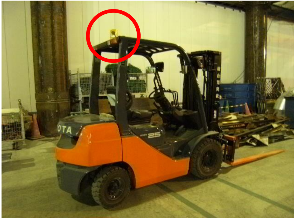
フォークリフト上部に回転灯を表示して、周辺作業員へのみえる化
